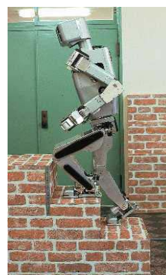
Rys. nr 6 Roboty humanoidalne H6 i H7. Z prawej strony ukazana możliwość pokonywania przeszkód.[5]
